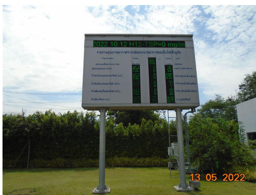
ภาพที่ 2-3 จอแสดงผลการตรวจวัดคุณภาพอากาศจากปล่องระบายบริเวณหน้าโครงการ
